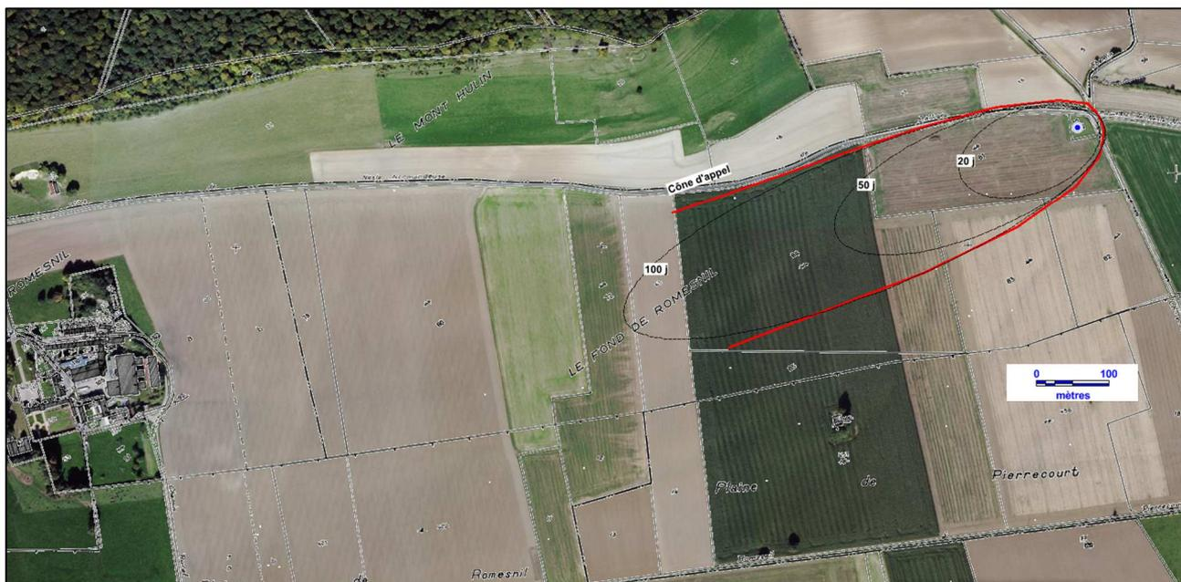
L'extension est globalement assez limitée, ceci est cohérent avec les résultats des essais de pompage de 2018 (transmissivité assez faible) et montrant l'existence d'une zone moins transmissive au-delà d'une certaine distance (limite étanche théorique : 60 m)
