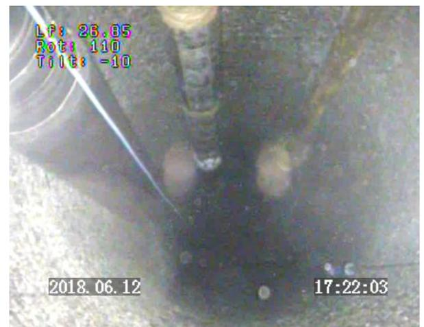
2<sup>nd</sup> palier (21 m<sup>3</sup>/h) - Prof 26.85 m : pompe d'exploitation n°1 et pompe d'essai
