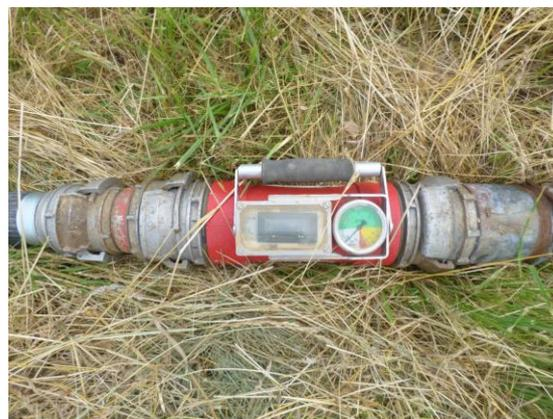
Débitmètre de la pompe d'essai et son afficheur
