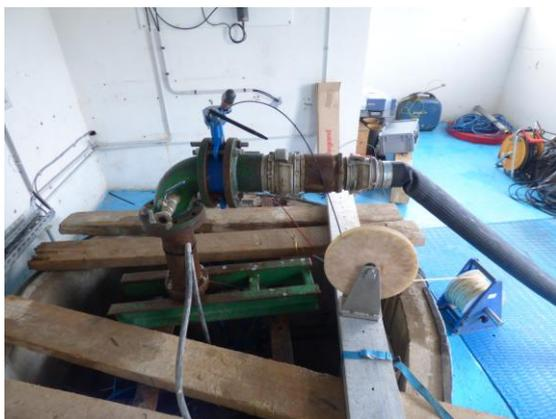
Vanne de régulation de la pompe d'essai
