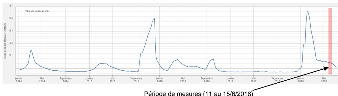
**Figure 11** - Niveau piézométrique dans le piézomètre de référence sur la commune de Réalcamp (22)
