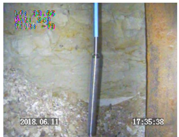
Prof 33.65 m : fin de l'inspection / sonde de pression / tube acier en petit diamètre posé au fond
