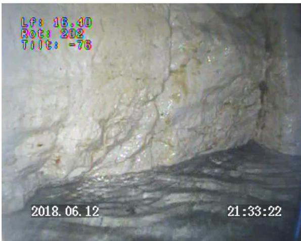
**4<sup>ème</sup> palier (46.7 m<sup>3</sup>/h) - Prof 16.10 m : surface piézométrique / fractures dans la craie avec écoulement d'eau**
